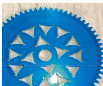
保護膜塗布による養生
